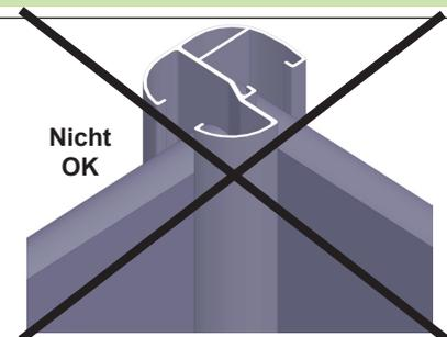
**ACHTUNG:** Bei der Montage von Sichtschutzzäunen mit Eckzaunpfosten müssen die Pfosten **ZWINGEND** verankert werden, um eine erhöhte Windfestigkeit (über 90 km/h) zu gewährleisten.
