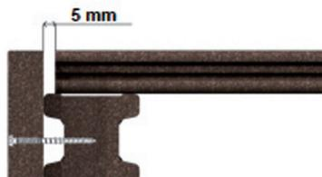
Bohren Sie das Profil mit einem Bohrer von 3,5 mm vor und schrauben Sie dann alle 40 cm eine Schraube direkt ein.
