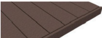
Zum Verdecken der Unterkonstruktion in der Längsrichtung (Dielen in Querrichtung) befestigen Sie das Abschlussprofil an der Unterkonstruktion und halten Sie einen Abstand von 5 mm zwischen den Dielen ein.
